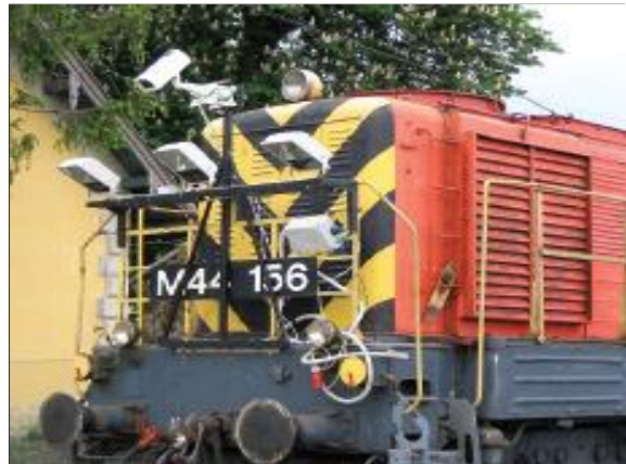
Weed Free Spray Train mostrando el sistema de cámaras, de boquillas pulverizadoras y equipo informático
