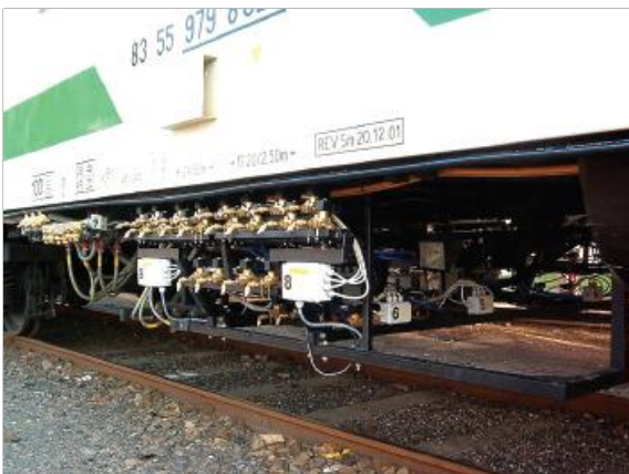
Weed Free Spray Train mostrando el sistema de cámaras, de boquillas pulverizadoras y equipo informático
