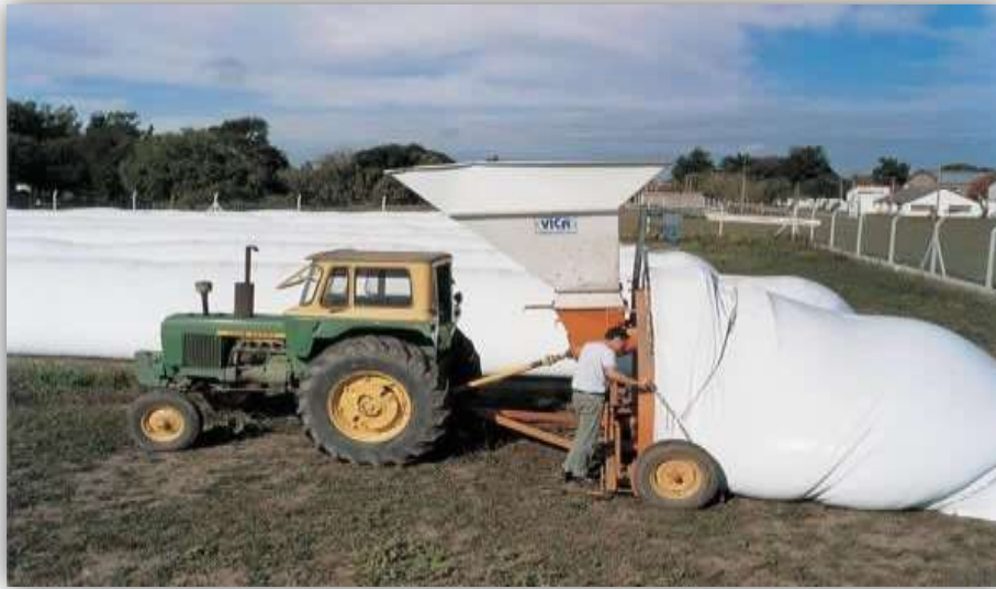
Equipo de llenado de silo bolsas en establecimiento productor. Fuente: Plastar S.A.
